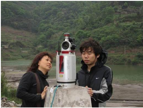
三维激光扫描现场监测
